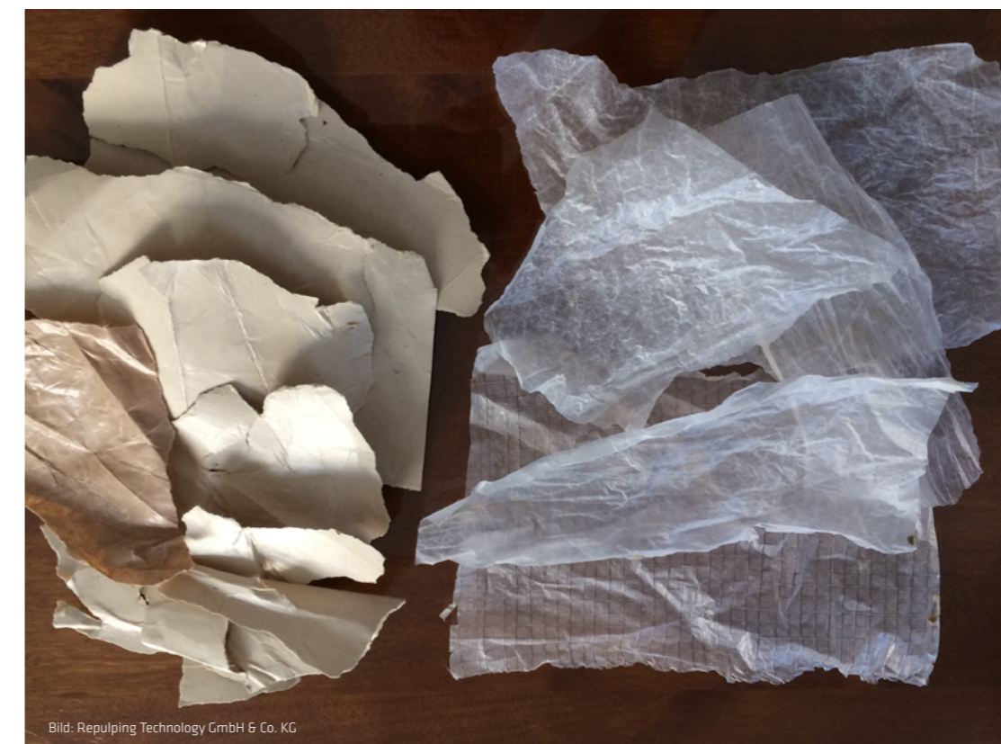
Vorher-/Nachher: Links ein zerrissener Coffee-to-Go-Becher, rechts herausgelöstes flächiges Polyethylen
